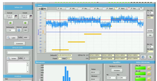
Prozessdatenerfassung (Prozessdaten und Prüfergebnisse werden gemeinsam gespeichert)
